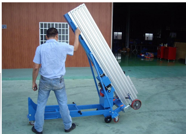
Basculement aisé du mât pour un transport dans le sens de la longueur
