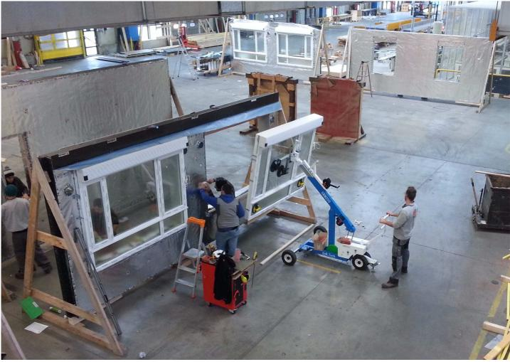
Dispositif de translation horizontale du palonnier pour faciliter l'installation du vitrage
