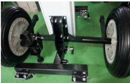
Schiebe – Fahrwerk mit 4 Räder und Bremse
