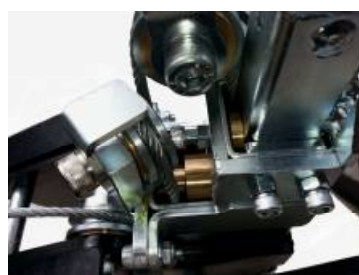
Movimento dotato di bronzine per lo scorrimento
