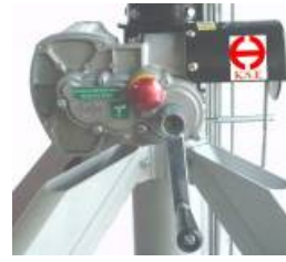
Hand-Betrieb bei Stromausfall durch eine Handkurbel
