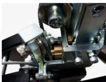
Mécanique de précision avec bagues en bronze
