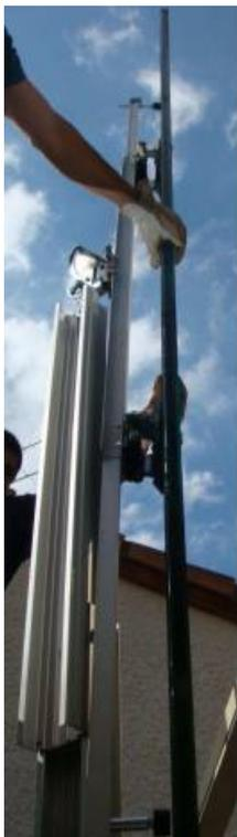
Il sollevatore per vetri **CA 400 GL** è l'alleato professionale per l'installazione di vetri su tetti e verande. Il design è costituito da tre elementi portanti: il supporto per vetro opzionale, il contrappeso mediante cui lavorare in facciata e la colonna motorizzata (230V con variatore di velocità).
